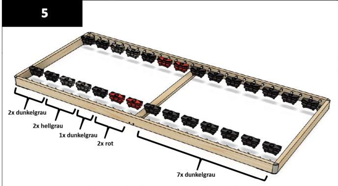
Stecken Sie die Kautschukkappen G, H und I auf die Bolzen im Außenholm A. Falls notwendig können Sie hierzu einen Hammer zur Hilfe nehmen.
